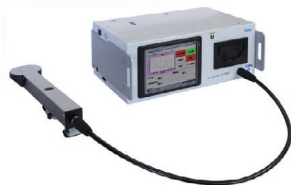
図2. 近赤外光食肉脂質測定装置 (枝肉切開面第6肋骨面側筋肉間脂肪で測定)
